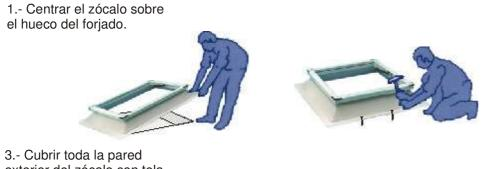
2.- Fijar el zócalo a la cubierta con tirafondos o clavos de acero.
